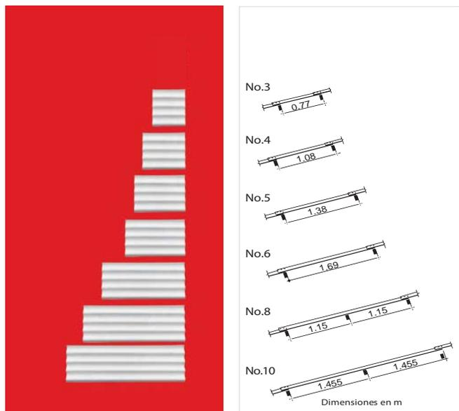
Fijación con dos ganchos según la estructura utilizada: madera, metálica o concreto, en zonas de fuertes vientos usar 2 ganchos y 2 tornillos.
